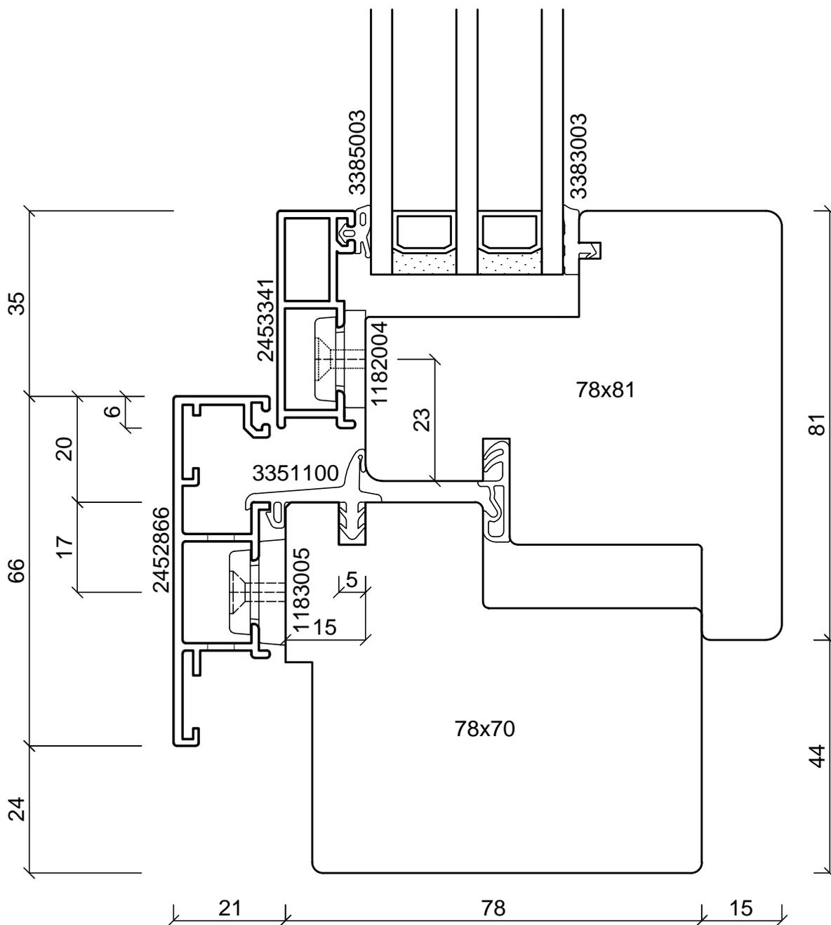
Aufbau Brüstungsscheibe: VSG aus ESG 6 mm / PVB 0,76 mm / ESG 6 mm
